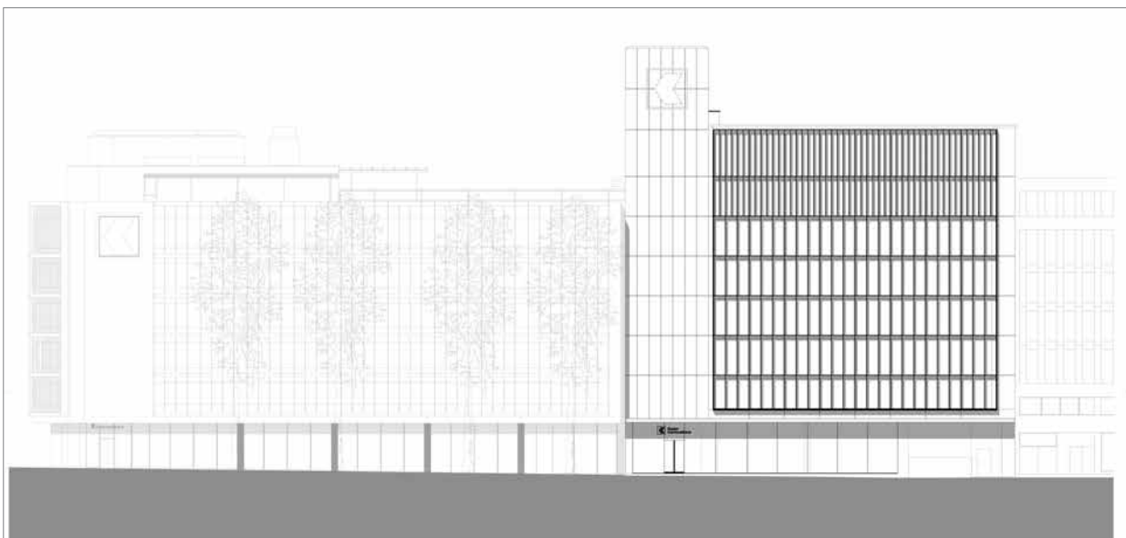
Die vorgehängte Fassade differenziert über dem Sockel zwischen Hauptgeschossen und einem Attikabereich.
